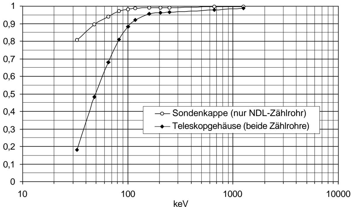
Die Sondenkappe kann nur die Anzeige des NDL-Zählrohres beeinflussen, weil sie das HDL-Zählrohr nicht bedeckt. Bei Energien oberhalb 65 keV beträgt ihr Durchlassvermögen mindestens 0,94, d.h. sie absorbiert maximal 6%. Die Sondenkappe wirkt sich damit auf die Energieabhängigkeit nur sehr gering aus.
