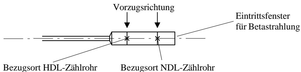
Das Betafenster der Sonde ist wasserdicht ausgeführt, sein Flächengewicht beträgt ca. 25 mg/cm<sup>2</sup>.
