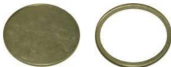
120 mm Ø Probenschalen in 3 mm und 8 mm Höhe
