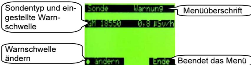
Die Warnschwelle kann in einem Bereich von 0,1  $\mu\text{Sv/h}$  bis 19,99 mSv/h eingestellt werden. Zur Umschaltung der Einheit diese anwählen und mit den Pfeiltasten die gewünschte Einheit  $\mu\text{Sv/h}$  oder mSv/h einstellen.
