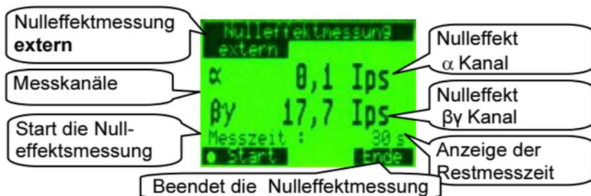
Der ermittelte Nulleffektmesswert wird im CoMo für diesen Sondentyp gespeichert und zur Berechnung des Nettomesswertes herangezogen. Wird später ohne externe Sonde gemessen, ist der interne Nulleffektmesswert wieder gültig.
