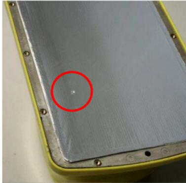
Ein Stück Folie mit einem scharfen Messer oder einer Schere ausschneiden (ca. 1cm umlaufend größer als die Beschädigung).
